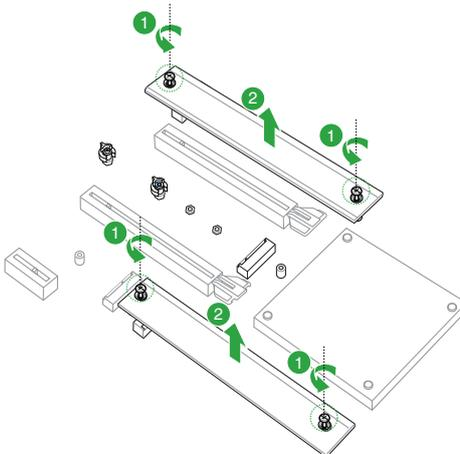
3. Installieren Sie Ihr M.2 in Ihrem M.2 Steckplatz. Die Schritte können bei der Installation von M.2 verschiedener Länge unterschiedlich sein. Bitte geben Sie auf die verschiedenen Typen und deren Installationsschritte unten acht:
